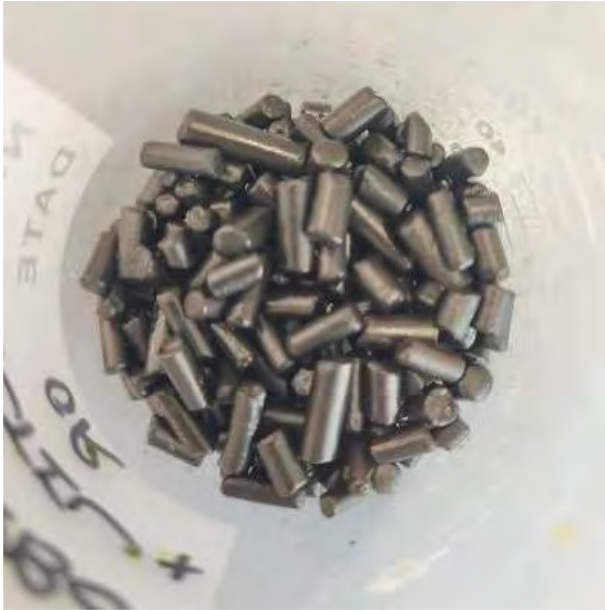
Carbó activat de tipus granular que utilitzem per eliminar l'or de la fase líquida.
