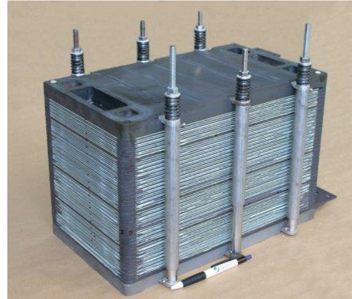
Pila SOFC de 5 kW, Jülich Research Center
